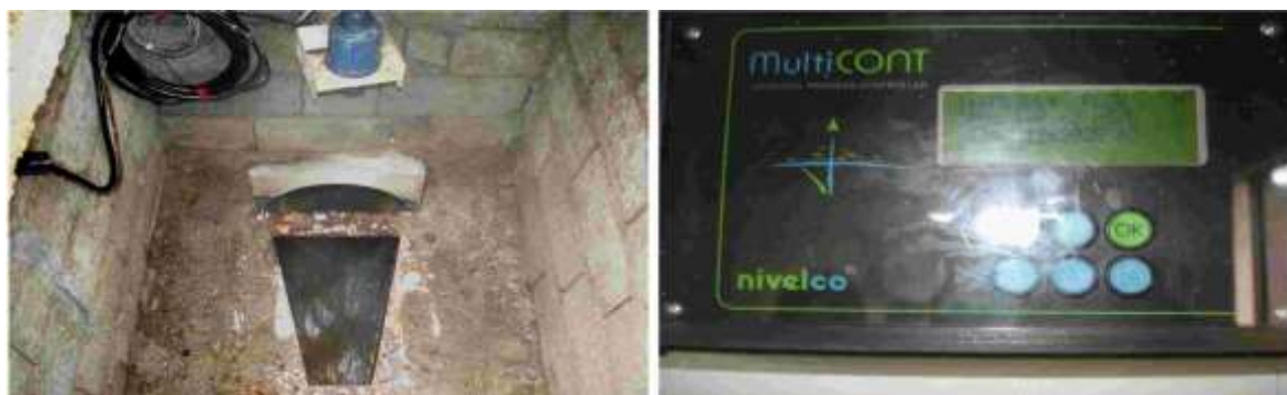
Слика 2: Мерни профил са дисплејом мерача протока на Трговишком Тимоку
