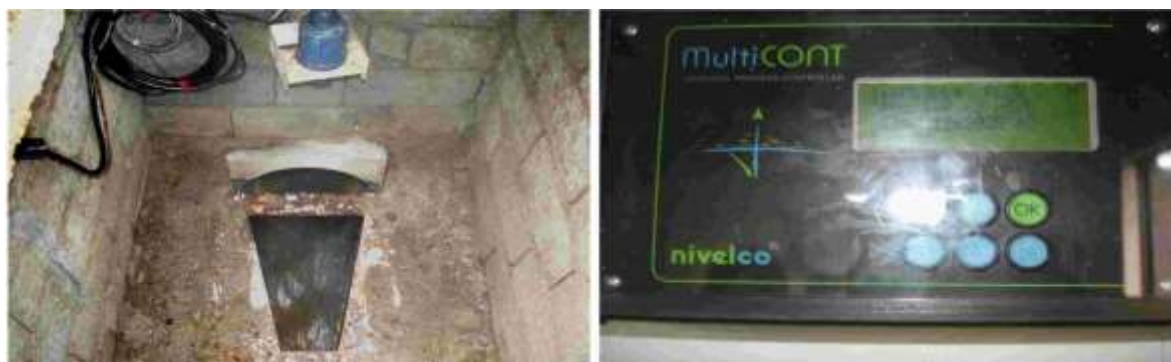
Слика 2: Мерни профил са дисплејом мерача протока на Трговишком Тимоку
